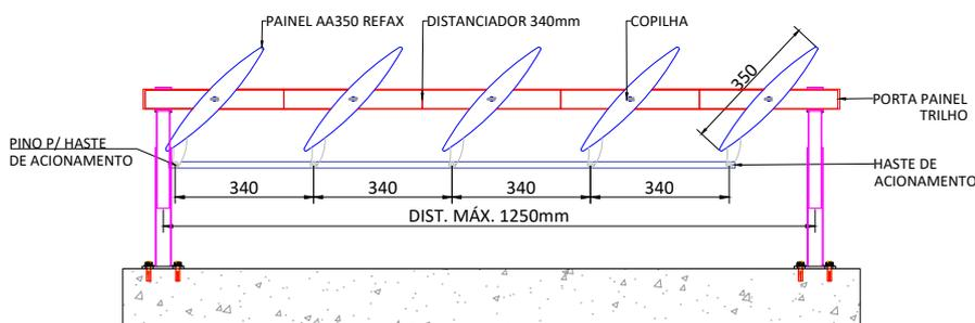
\*AS LÂMINAS POSSUEM PREENCHIMENTO INTERNO DE PU EXPANDIDO.
