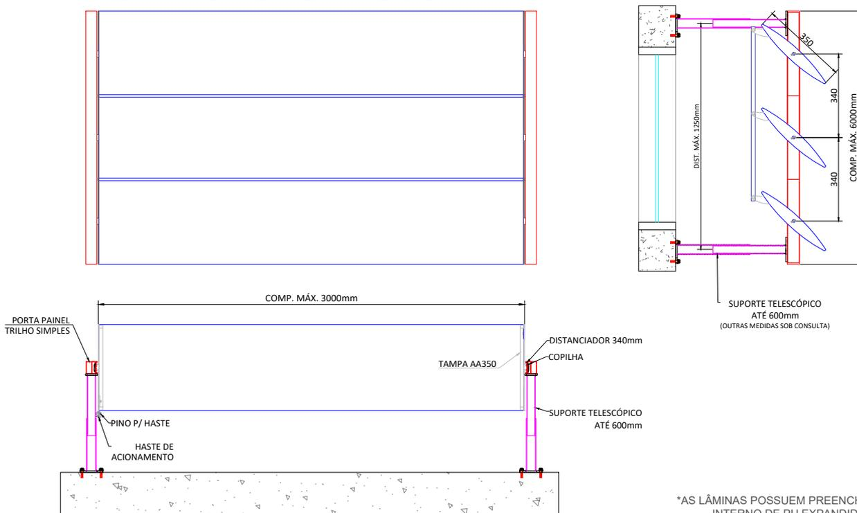
\*AS LÂMINAS POSSUEM PREENCHIMENTO INTERNO DE PU EXPANDIDO.
