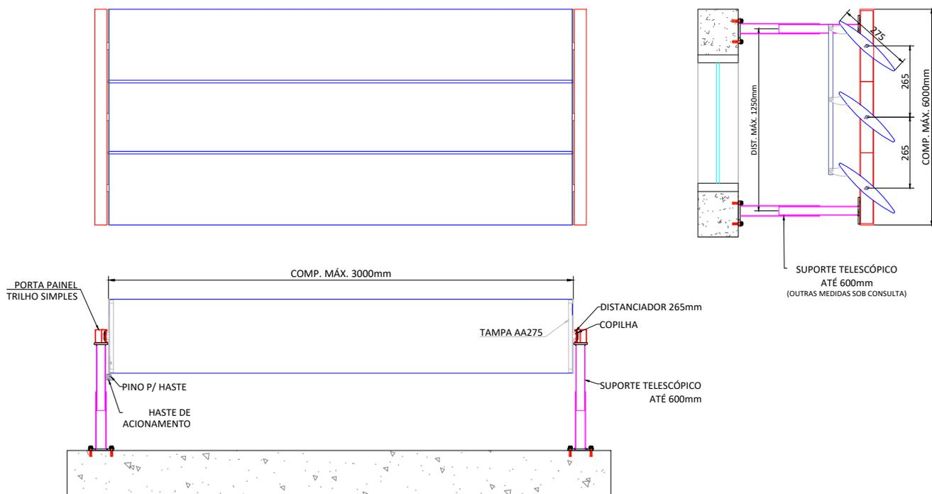
\*AS LÂMINAS POSSUEM PREENCHIMENTO INTERNO DE PU EXPANDIDO.
