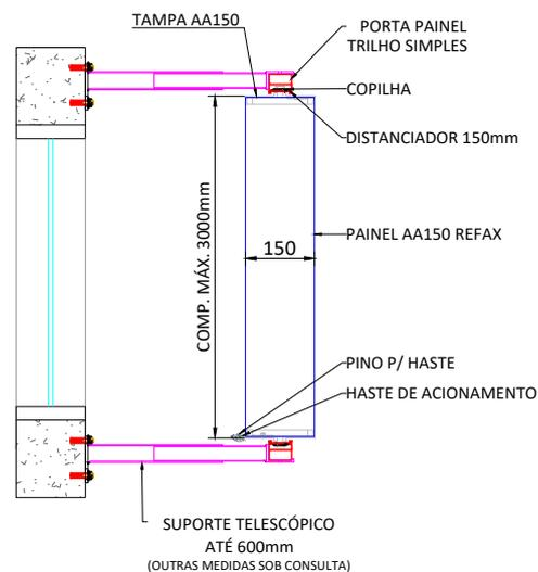
\*AS LÂMINAS POSSUEM PREENCHIMENTO INTERNO DE PU EXPANDIDO, OPÇÕES LÂMINAS SEM PREENCHIMENTO CONSULTE NOSSO DEPARTAMENTO TÉCNICO.
