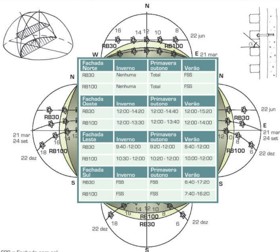
Máscara de insolação para o brise RB30 e RB100 na horizontal
